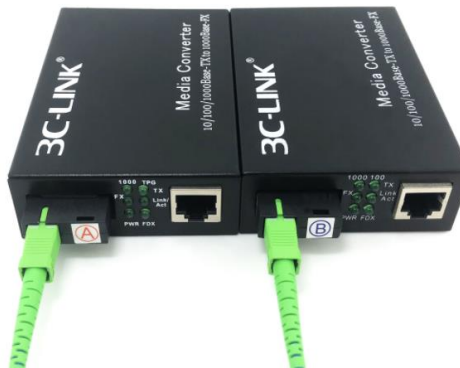
Gambar 3.5. Contoh media converter sepasang.
